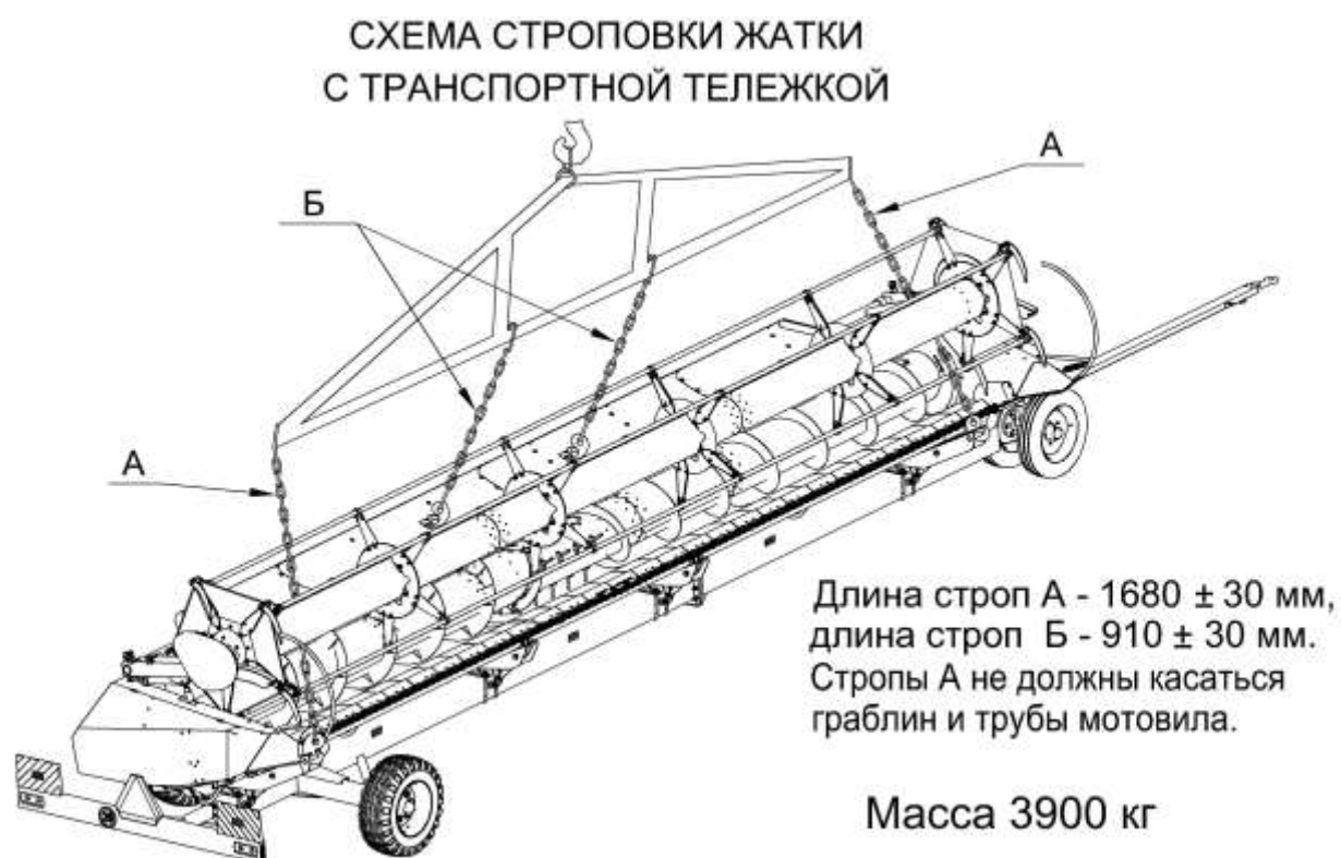
Рисунок 6.1 – Строповка жатки с тележкой
